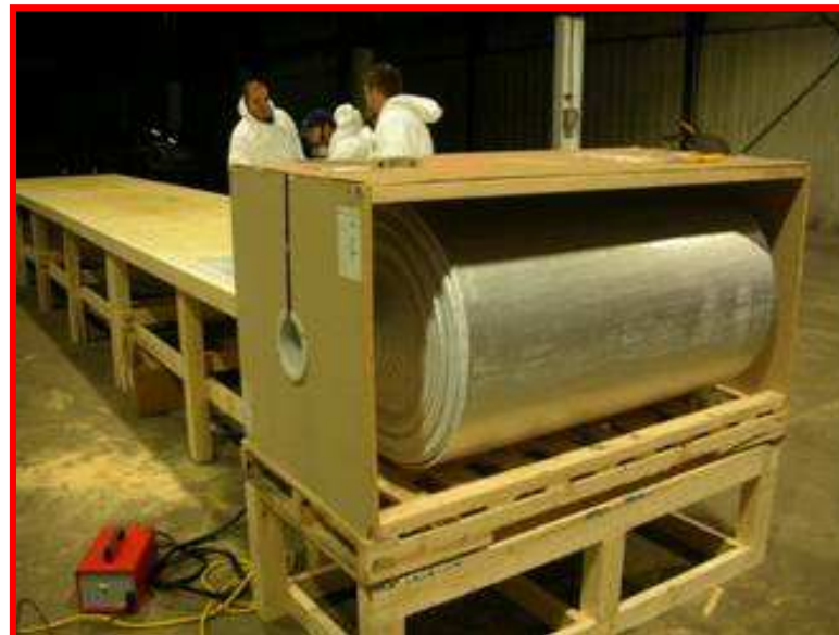
Rozłożenie i cięcie na żądany wymiar
